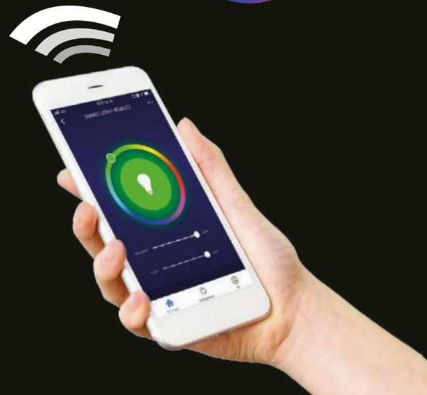
**Luminaria Wifi Inteligente** Se controla mediante un teléfono inteligente permitiendo ajustar el flujo luminoso y la temperatura de color. Utiliza una red WIFI que debe tener acceso a internet.
