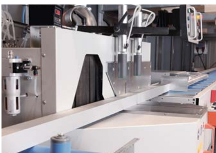
45° und 135° Gehrungsschnitt / 45° and 135° mitre cut
