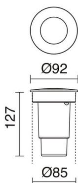
Empotrable de suelo Belgrado-9, fabricado de resina en color negro con un grado de protección IP67, cuenta con tres tipos de luminaria mono emisión, doble emisión y triple emisión. Tiene incluida la lámpara. La profundidad de empotramiento es de 12cm. Son luminarias diseñadas para iluminar las zonas de paso comerciales o residenciales.
