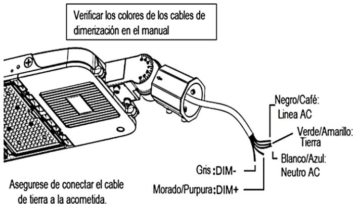
La señal de control para la atenuación debe cumplir con el estándar IEC 60929 Anexo E, que define el driver o balasto como fuente de corriente. Driver ensamblado en bandeja portaequipo anclada sobre la estructura interna de la luminaria, de fácil mantenimiento.
